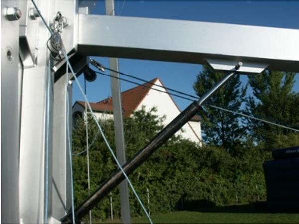
Durch einen Hydraulikzylinder werden die Ausleger nach oben gedrückt.
